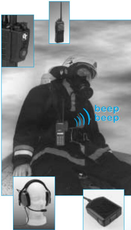
Frei programmierbare No-motion/Man-down-Elektronik integriert im Alarmgeber-Gehäuse zum Anschluss an das Funkgerät. Notruftaste zur willentlichen Alarmauslösung, Buchse für Zubehör-Anschluss
