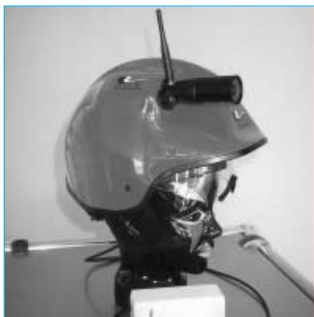
Auch für die visuelle Unterstützung der Audio-Kommunikation stehen bei CeoTronics entsprechende Systemlösungen zur Verfügung. Über eine am Helm angebrachte Miniaturkamera mit Sender können Videobilder vom Brandherd bzw. vom Einsatzort zur Leitstelle drahtlos per Funk übertragen werden.
